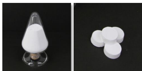
図：開発した酸化物系固体電解質の外観 左：粒状タイプ / 右：ペレットタイプ
